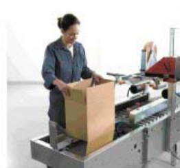
Der Karton wird zur Schiene geführt und anschließend werden die Seitenklappen auf der Unterseite gefaltet.
