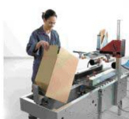
Die vordere und hintere Klappe werden in Richtung Schiene gefaltet.
